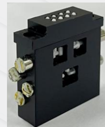
ต้นแบบเซลล์แสดงผลอักษรเบรลล์ ที่ขับเคลื่อนด้วยมอเตอร์
